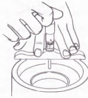
Figura 3-6 Cómo medir la profundidad de un reborde con un micrómetro de profundidad.
